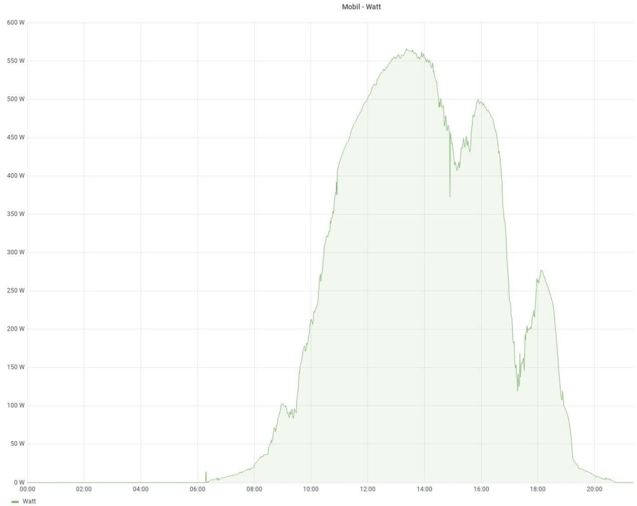
Ein Tag Ende April: von 09:00 bis 19:00 Uhr der Grundbedarf von ca. 150 Watt gedeckt.
