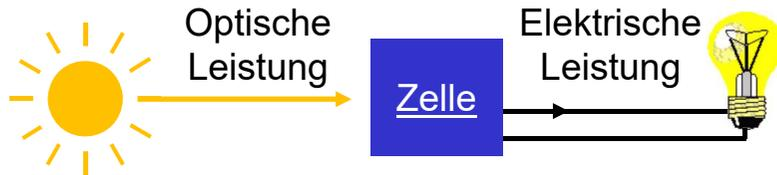
$$\eta_{\text{Modul}} = \frac{\text{Elektrische Leistung}}{\text{Optische Leistung}} = \frac{P_{\text{Elektrisch}}}{P_{\text{Optisch}}}$$
